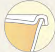
蒸気を逃がさない かぶせ蓋構造
